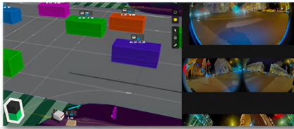
Визуализация результата работы алгоритмов восприятия ровера
